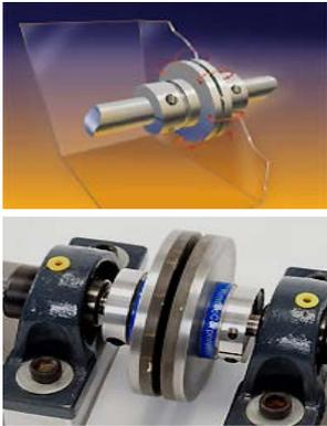
磁力によって非接触で動力伝達を行っていくことはマグネットカップリングと言います。非接触ですので液洩れや磨耗を防ぐことができますので化学工業や食品工業などをはじめ、たくさんの分野に利用されており、通常多極構成された永久磁石を2つ使用して作られています。
