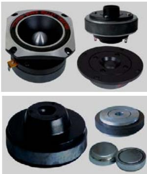
スピーカ磁気回路に使用している永久磁石はコスト・性能バランスが良いフェライト磁石が一般的ですが、コストが高くなりますが交流磁気抵抗が少なく音質に有利なアルニコ磁石も根強い需要があります。磁力の大きいネオジム磁石やサマリウムコバルト磁石なども小型スピーカによく使われております。
